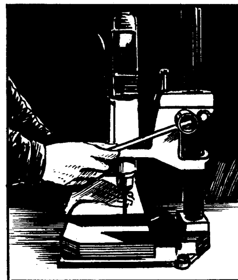
Рис.4. Сверление отверстий в блоке фанерных полос под шпильки
