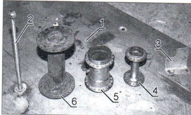
Приспособление для правки ободьев колёс и втулки:
