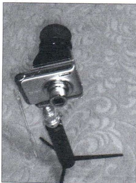
Компактная фотокамера с прикрытием дисплея от яркого света коробом-«шахтой»
