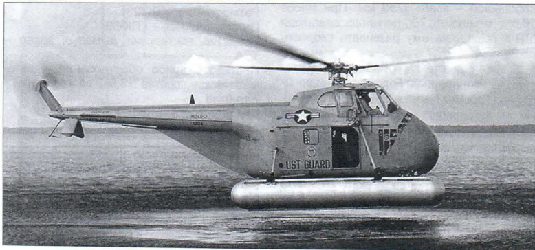
Вертолёт береговой охраны США Н-19А с поплавковым шасси совершает посадку на воду
