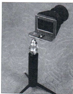
Приставка из кронштейна и короба-«шахты» с трёхкратной лупой с диоптрической регулировкой
