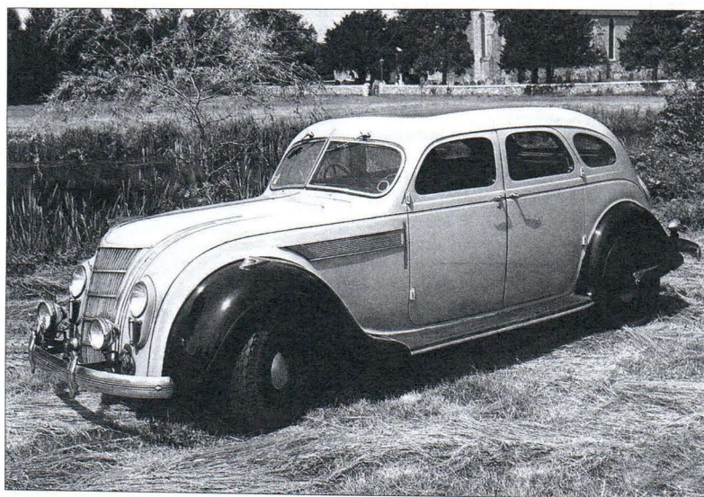
«Аэродинамический» автомобиль Chrysler Airflow с кузовом обтекаемой формы – один из первых, спроектированных с использованием аэродинамических расчетов и продувок моделей машины в аэродинамических трубах (1934 г.)
