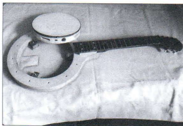
Сборка конструктивных элементов банджо – установка бубна в корпус
