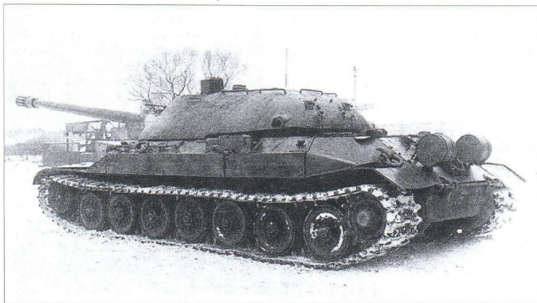
Тяжёлый танк ИС-7 («объект 260»). К лету 1948 г. на Ленинградском Кировском заводе было изготовлено четыре опытных образца танка
