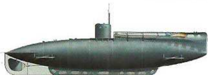
Подводная лодка типа А при вступлении в строй (без увеличенной рубки), 1916 г.
