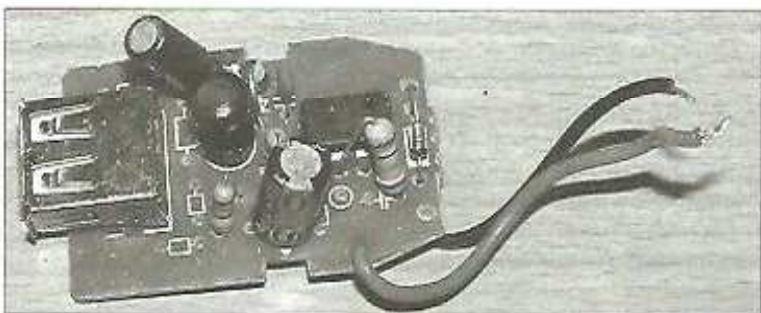
Фото 2. Внешний вид печатной платы с установленными дискретными элементами и микросхемой
