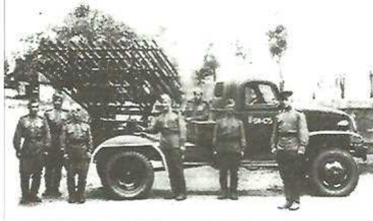
БМ-8-48 с двумя пакетами рельсовых направляющих на базе грузовика «Шевроле» G-7107. 1943 г.
