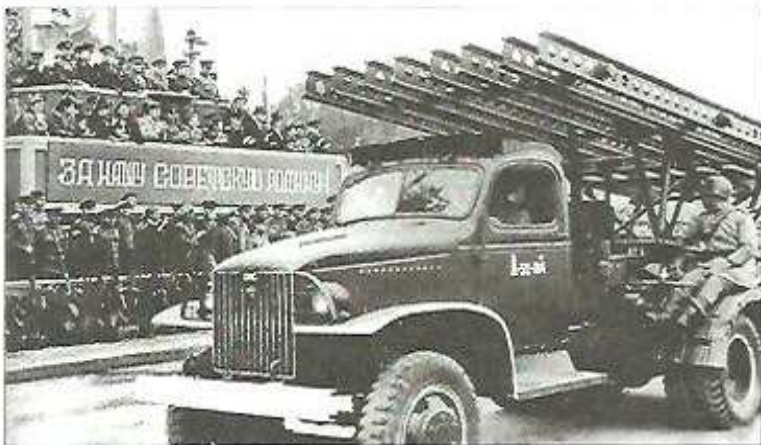
Установка БМ-13 на шасси американского грузового военного автомобиля GMC CCKW-353 (2x4) на одном из парадов в Германии. 1945 г.
