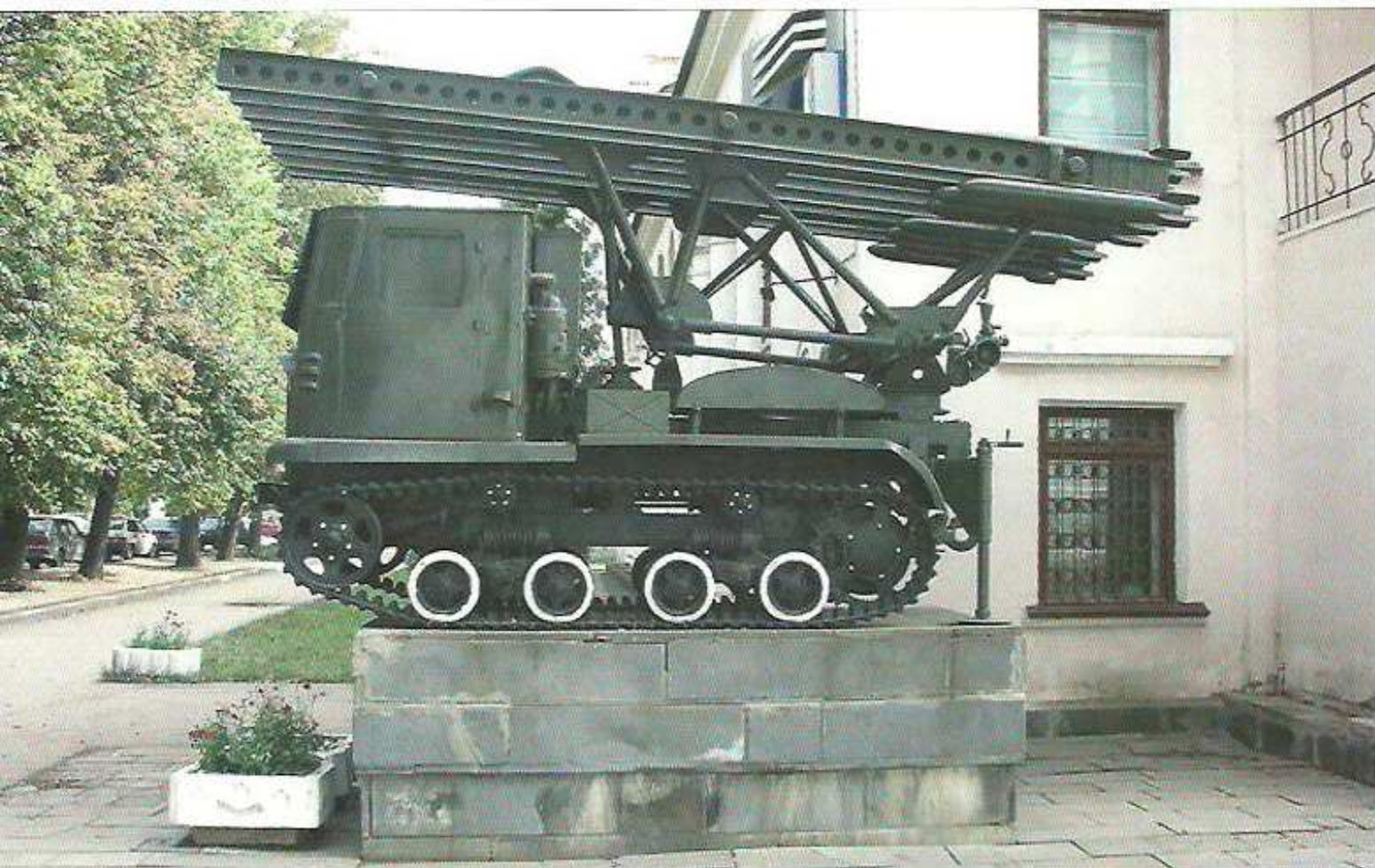
Восстановленная установка М-13 на шасси трактора СТЗ-НАТИ (СТЗ-5) возле здания Новомосковского историко-родождественного музея (Тульская область). Машина затонула 14.12.1941, поднята с десятиметровой глубины Шаховского водохранилища 25 ноября 1988 г. водолазами группы «Поиск» московского завода ГПЗ-1
