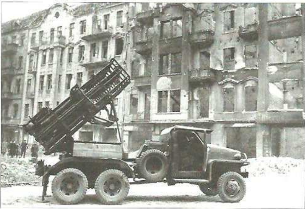
Гвардейский реактивный миномёт БМ-31-12 в Берлине. Стрельба велась снарядами калибра 310 мм, запускавшимися с 12 направляющих сотового типа. Система размещена на шасси ленд-лизовского грузовика «Студебекер» US6
