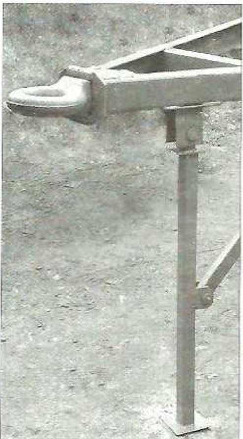
Передний конец дышла с кольцом для сцепки с тягачом, установленный на опору
