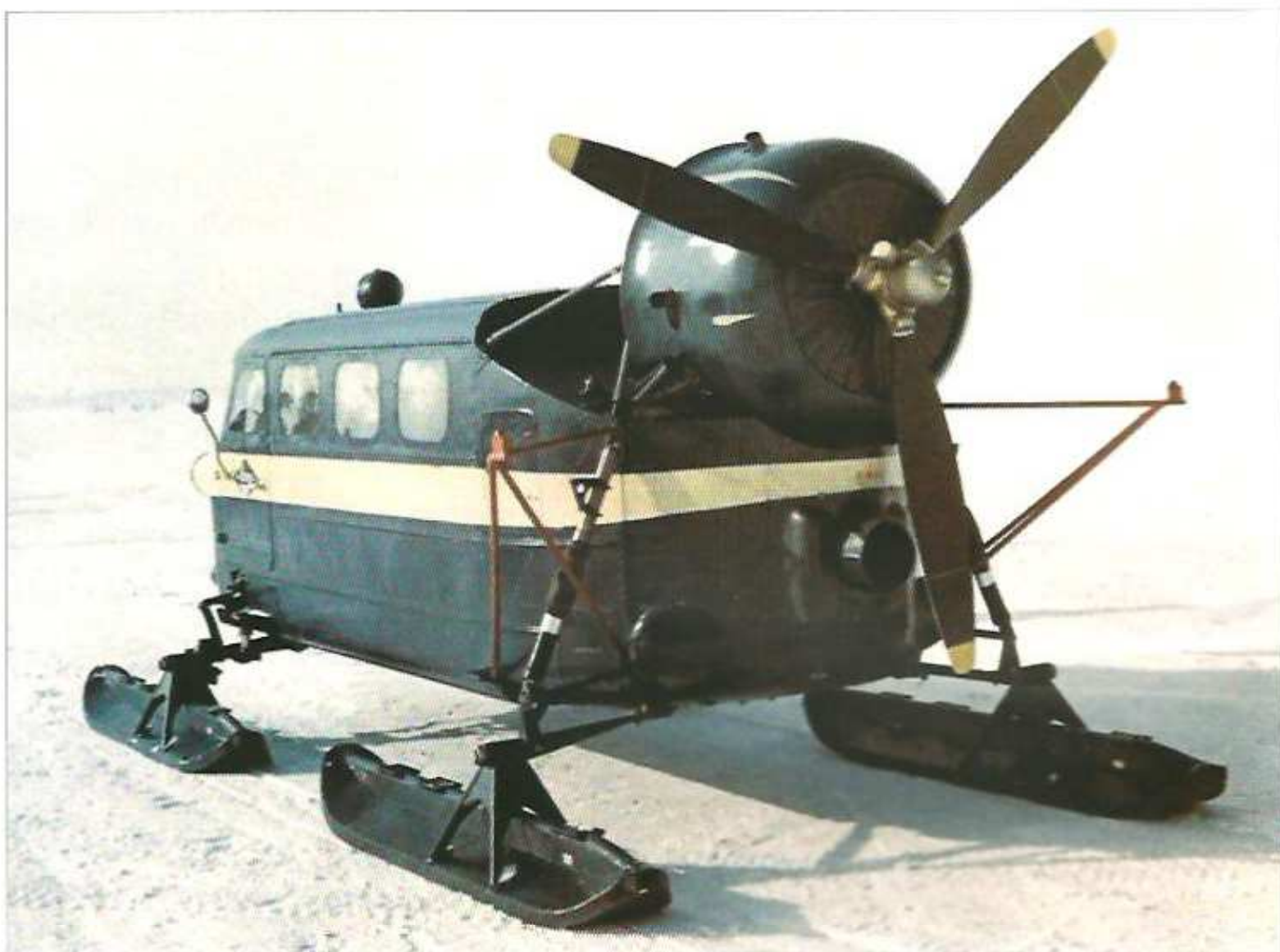
Ка-30 – десятиместные четырёхлыжные грузопассажирские аэросани
