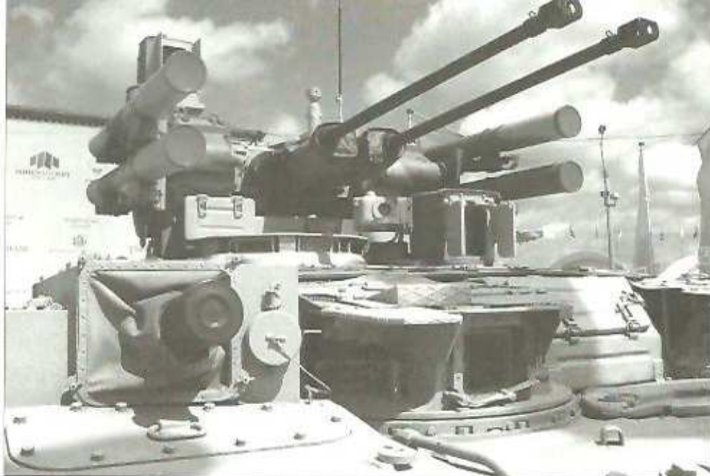
Башня БМПТ. По правому борту – гранатомёт АГ-12Д в спонсоне, справа от него – прицел ПНК-4 «Агат-МР» стрелка-гранатомётчика, выше – прицельный комплекс Б07-41 командира
