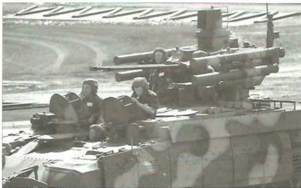
Экипаж БМПТ: механик-водитель, два бортовых стрелка-гранатомётчика, командир машины – по правому борту, наводчик-оператор – слева от него
