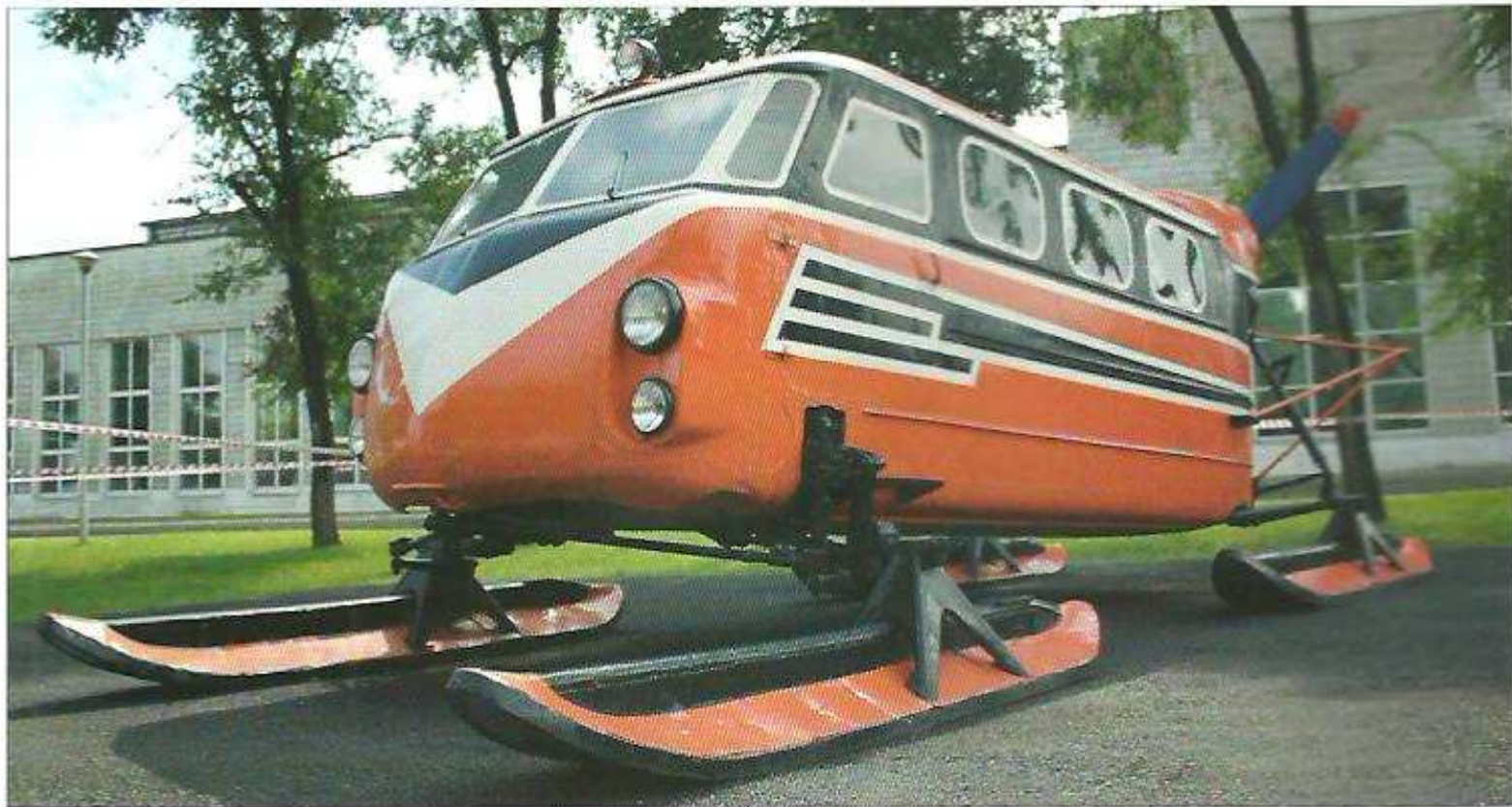
Ка-30 – десятиместные четырёхлыжные грузопассажирские аэросани
