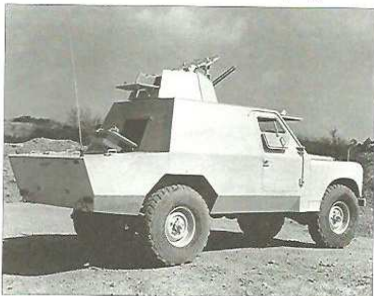
Броневик Shorland модели Mark II. Броня машины – 8,25 мм. Двигатель мощностью 70 л.с. 1968 г.
