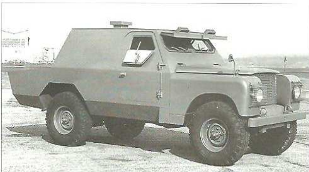
Командирская машина со снятой башней и дополнительным вентилятором на крыше
