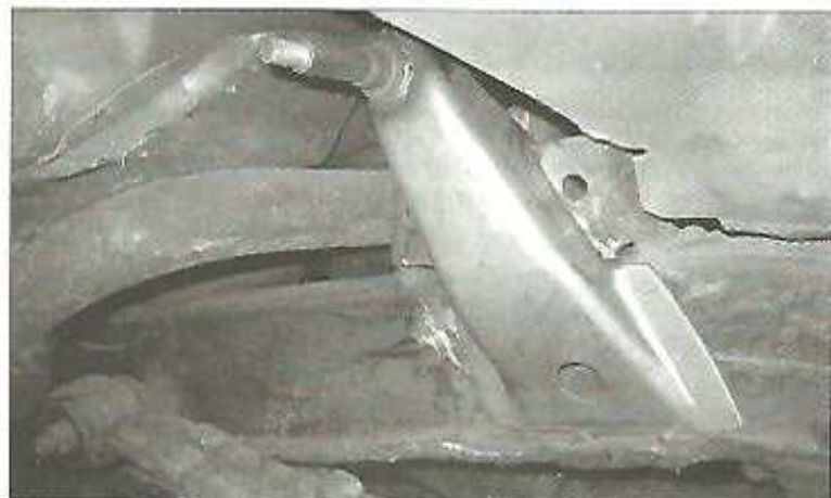
Новый кронштейн от UA3-469, приваренный к старой раме UA3-69 для амортизатора «Плаза»
