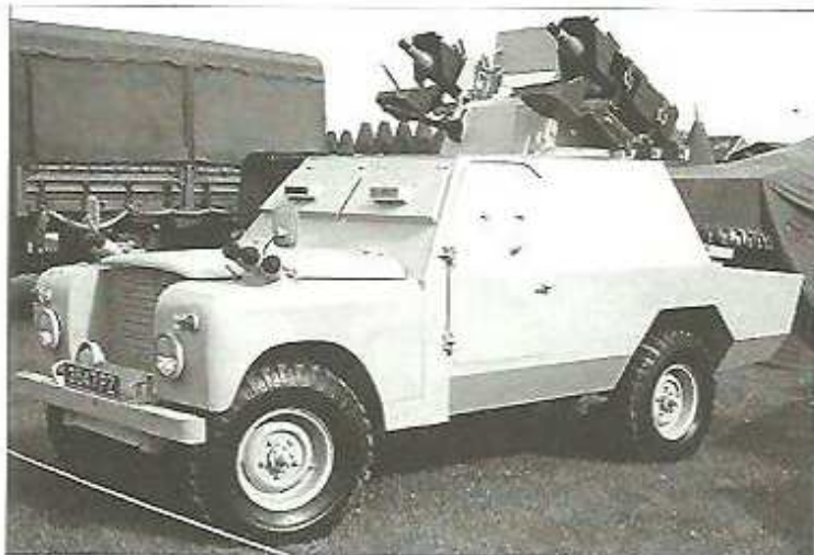
Опытный образец противотанкового ракетного комплекса на базе Shorland. На башне установлены две пусковые установки управляемых ракет Vigilant. 1967 г.
