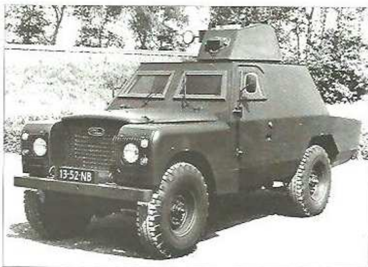
Полицейский вариант SB 303. Башня специально приспособлена для стрельбы из снайперской винтовки. 1975 г.
