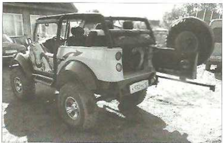
Задняя распахивающаяся дверь на монопетле и запасное колесо на поворотной консоли («калитке»)
