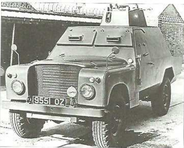
Броневедомо-автомобиль Shorland Mark I с башней от бронетранспортёра Ferret с 7,62-мм пулемётом Browning. 1965 г.
