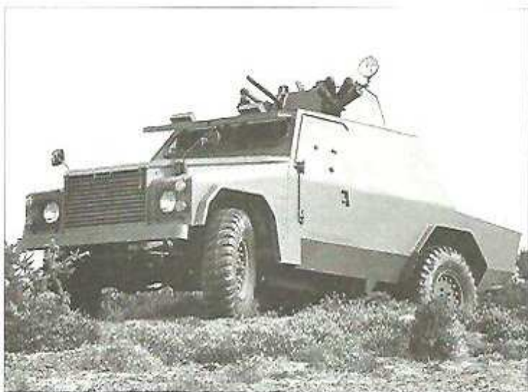
Базовая модель автомобиля SB 51 серии Mark V с пулемётной башней на крыше и двумя блоками пусковых установок дымовых гранатомётов. 1995 г.
