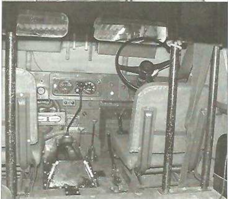
Отсек управления. Управление машины полностью идентично базовому Land Rover. Справа находился водитель, слева – командир
